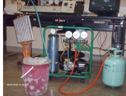
Figura No.9. Carga de refrigerante en frío, con hielo seco
