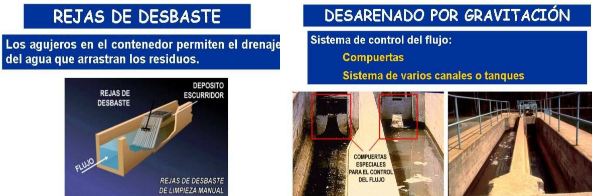
Figura No. 7. Ejemplo de desarenadores
